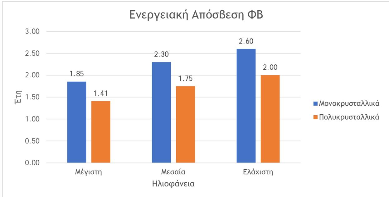
**Διάγραμμα 8.6 Χρόνος ενεργειακής απόσβεσης ΦΒ συστημάτων με μονοκρυσταλλικά και πολυκρυσταλλικά πλαίσια - κυπριακές συνθήκες ηλιοφάνειας (Μέγιστη 1,800 kWh/kWp/έτος - Μέση Μέγιστη 1,450 kWh/kWp/έτος - Ελάχιστη Μέγιστη 1,275 kWh/kWp/έτος)**
