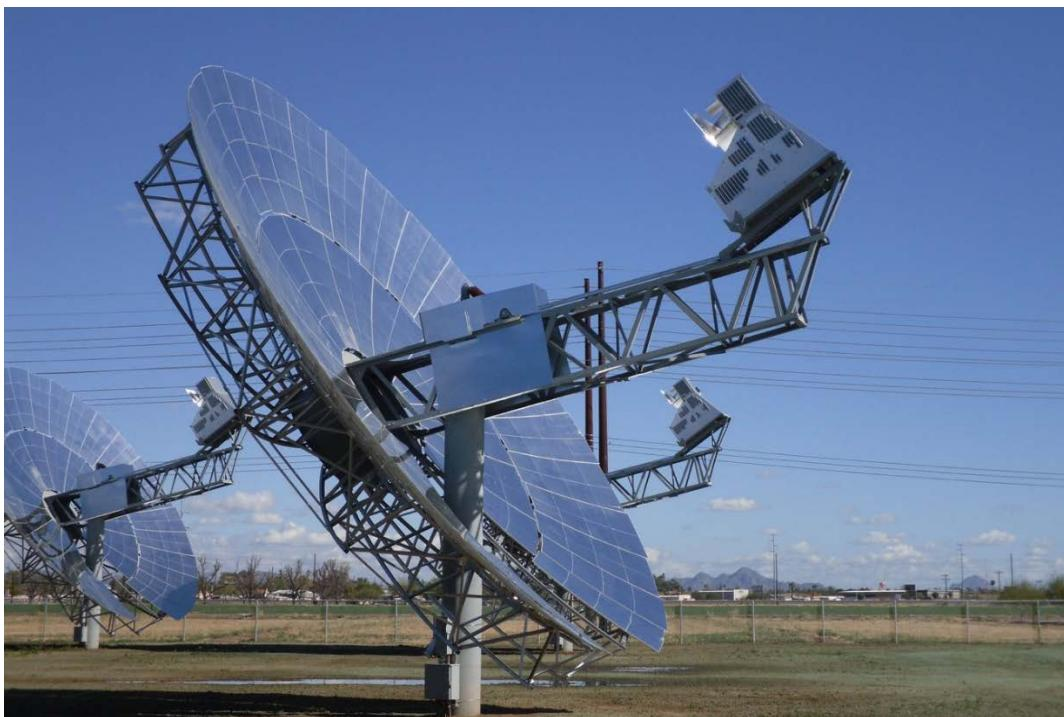
**Εικόνα 3.4. Solar Power Stirling Engine**
